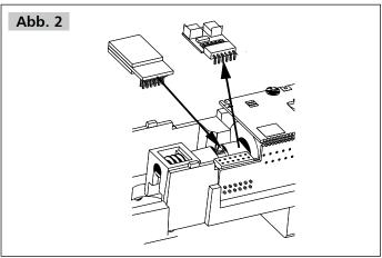
Zum Einbau eines PluX12-Decoders nach NEM 658 wird der Entstörsatz mit dem Adapterleiterplatte abgezogen. Danach kann ein PluX12-Decoder eingesteckt werden.
