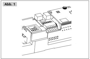
Für eine Digitalisierung gibt es im Modell eine PluX12-Schnittstelle. Wir empfehlen die Verwendung eines Decoders PluX12 von Uhlenbrock (TILLIG Art.-Nr. 66035). Zum Einbau des Decoders ist das Oberteil entsprechend der Anleitung auf Seite 1 abzunehmen. Seitlich in der Rahmenaussparung befindet sich die Decoderschnittstelle.
