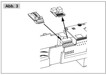
Zum Einbau eines Decoders nach NEM 651 S klein wird nur der Entstörsatz abgezogen. Danach kann ein Decoder nach NEM 651 S klein eingesteckt werden. Hierfür empfehlen wir den Decoder von Uhlenbrock (TILLIG Artikel-Nr. 66032).
