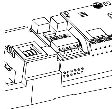
**(DE)** Für eine Digitalisierung gibt es im Modell eine PluX12-Schnittstelle. Wir empfehlen die Verwendung eines Decoders PluX12 von Uhlenbrock (TILLIG Art.-Nr. 66035). Zum Einbau des Decoders ist das Oberteil entsprechend der Anleitung auf Seite 1 abzunehmen. Seitlich in der Rahmenaußsparung befindet sich die Decoderschnittstelle.
