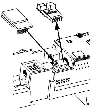
**(DE)** Zum Einbau eines PluX12-Decoders nach NEM 658 wird der Entstörersatz mit dem Adapterleiterplatte abgezogen. Danach kann ein PluX12-Decoder eingesteckt werden.
