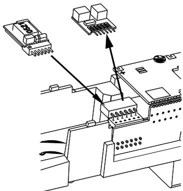
**(DE)** Zum Einbau eines Decoders nach NEM 651 S klein wird nur der Entstörersatz abgezogen. Danach kann ein Decoder nach NEM 651 S klein eingesteckt werden. Hierfür empfehlen wir den Decoder von Uhlenbrock (TILLIG Art.-Nr. 66032).
