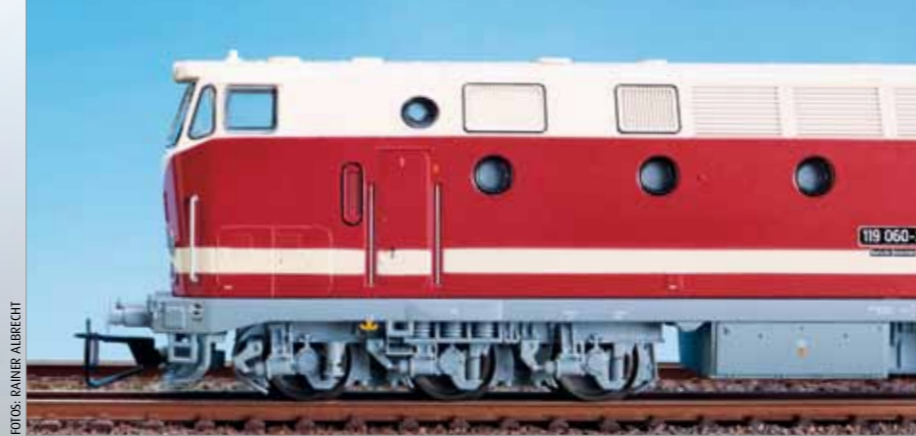
Feine Gravuren, saubere Lackierung und exakte Bedruckung, hochdetaillierte Drehgestelle mit Tiefenwirkung; bei so vielen Pluspunkten stört nur die antiquierte Kupplung.
