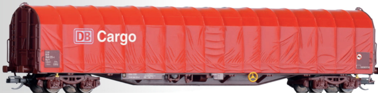
Schiebepalenwagen Rils 652 der DB Cargo Sliding tarpaulin car Rils 652 of the DB Cargo
