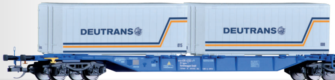
Doppeltragwagen Sggnos 715, Kombiwaggon, der DR, beladen mit vier Wechselbehältern DEUTRANS Container car Sggnos 715, Kombiwaggon of the DR with load
