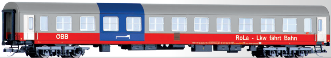
RoLa-Begleitwagen Bcm, Bauart Halberstadt, der ÖBB RoLa-Begleitwagen Bcm, Bauart Halberstadt, of the ÖBB
