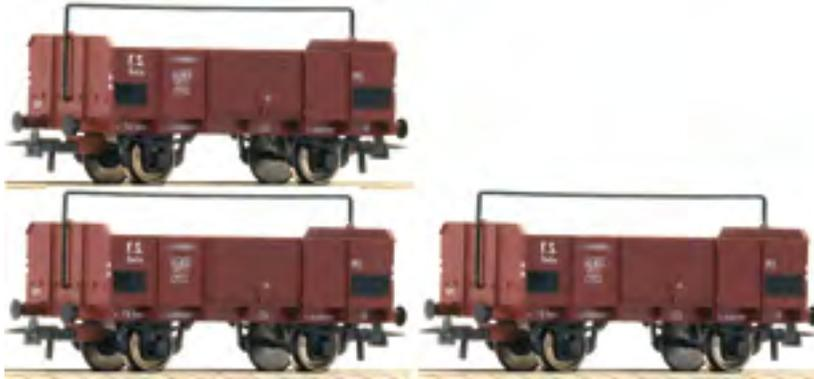
Vorbild sind drei offene Güterwagen Bauart L der Italienischen Staatsbahnen. Fein detaillierte Modelle in der Ausführung mit Spriegelstange.
