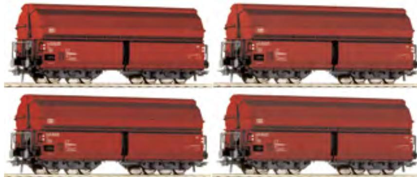
Vorbild sind vierachsiger Selbstentladewagen mit Schwenkdach Bauart Tal 963 der deutschen Bundesbahn.
