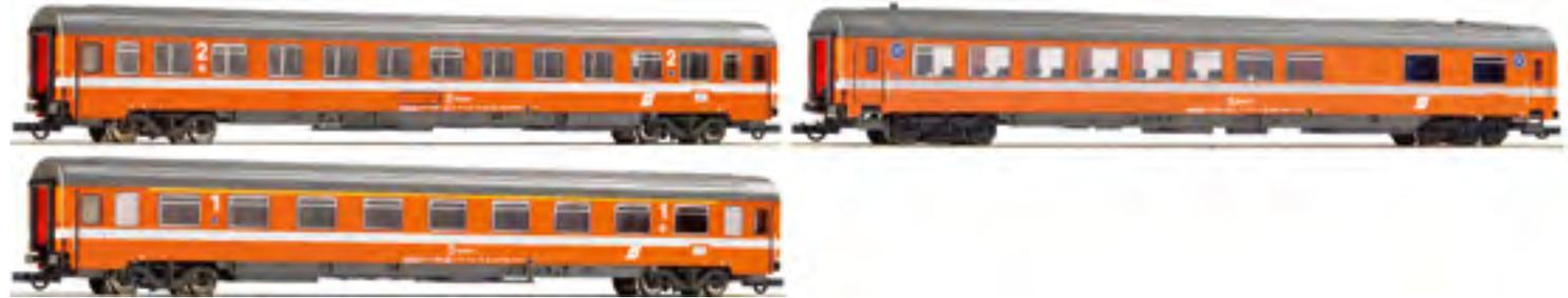
Vorbild sind drei Eurofima Reisezugwagen der Österreichischen Bundesbahnen. Das Set besteht aus einem Wagen 1. Klasse Bauart Amz, einem Wagen 2. Klasse Bauart Bmz, sowie einem Speisewagen Bauart WRmz.
