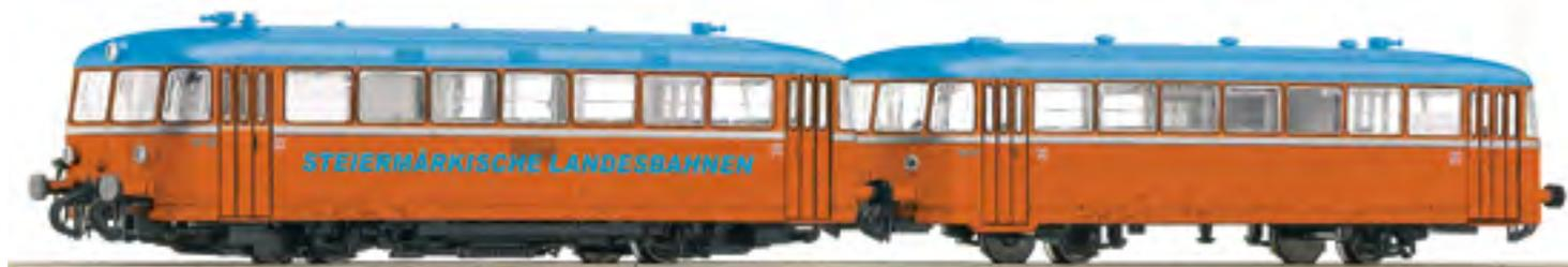
Vorbild ist ein Dieseltriebwagen VT 22 mit Steuerwagen der Steiermärkischen Landesbahnen.
