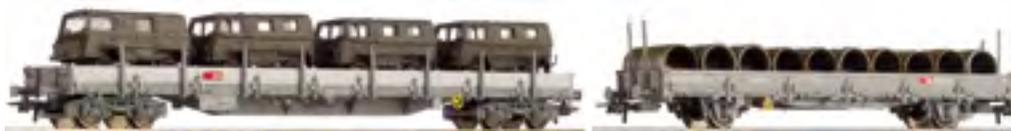
Vorbild ist ein Rungerwagen Bauart Res und ein Rungerwagen Bauart Ks der Schweizerischen Bundesbahnen beladen mit Pinzgauer Geländewagen der Schweizerischen Armee sowie mit Drahtrollen.
