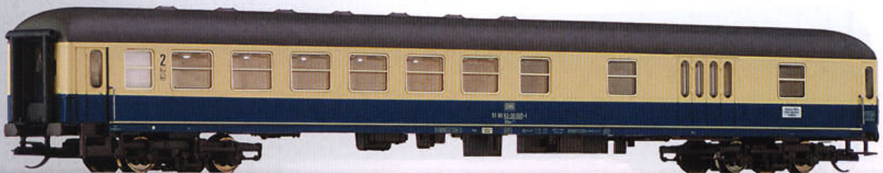
Reisezugwagen BDms 273, kombinierter Sitz- und Gepäckwagen der DB Passenger coach BDms 273, combined seating/baggage waggon of the DB
