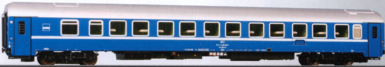
Schlafwagen WLABmee (62 21 71-90 238 1) der BC in aktueller blauer Farbgebung mit weißem Streifen, BC Sleeping coach type WLABmee (62 21 71-90 238 1) of the BC
