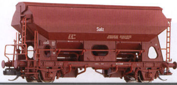
Schwenkdachwagen Tds-y für Salztransport der DR Swing roof car Tds-y „Salz“ of the DR
