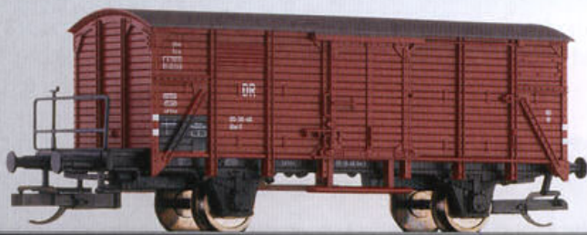
Gedeckter Güterwagen G der DR, mit Bremserbühne Box car G of the DR, with brakemans stand
