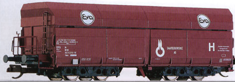
Selbstentladewagen, Falns „Eva“, eingestellt bei der DB High capacity hopper car, Falns „Eva“ of the DB
