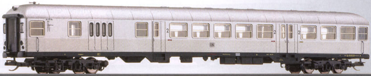
Steuerwagen „Silberling“ BD4nf der DB Driving cap coach „Silberling“ BD4nf of the DB
