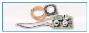
IntelliSound ist das neue digitale Sound-System von Uhlenbrock/DIETZ. Die bisher in HO nicht da gewesene Ton-Qualität und Originalität des Sounds wird Sie überzeugen. Die Trennung von Decoder und Sound in zwei sehr kleine Einheiten und dazu der extrem leistungsfähige Kleinlautsprecher mit Metallmembran machen IntelliSound auch bei beengten Platzverhältnissen gut einsetzbar.
