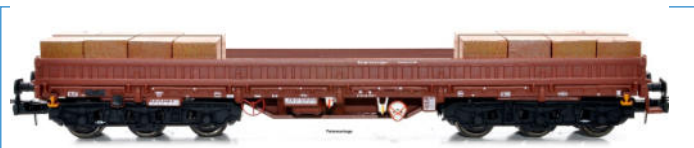
6-achsiger Schwerlastwagen der Bauart Samms 4860 der DR (Epoche V) Bergbremswagen Zwickau beladen mit Balastgewichten
