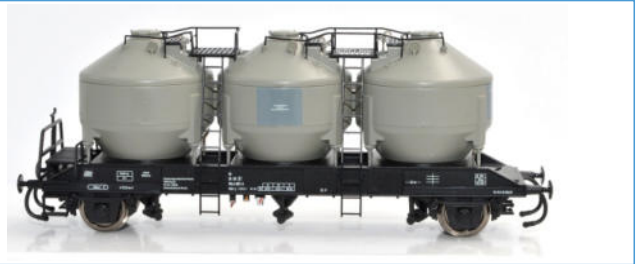
2-achsiger Silowagen Bauart Udd-y der DR (Epoche IV) zum Transport von Zucker, 1. Betriebs-Nr.
