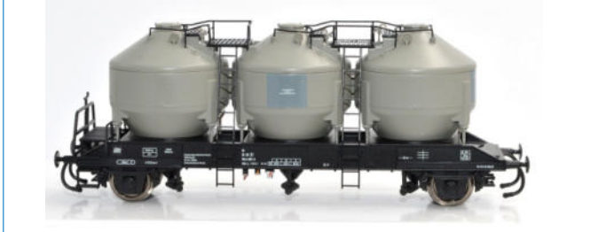
2-achsiger Silowagen Bauart Udd-y der DR (Epoche IV) zum Transport von Zucker, 2. Betriebs-Nr.
