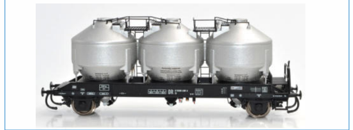
2-achsiger Silowagen Bauart Ud-y der DR (Epoche IV) zum Transport von Kunststoffgranulaten, 2. Betriebs-Nr.
