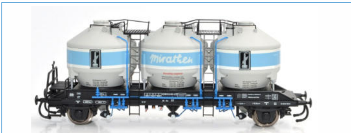
2-achsiger Silowagen Bauart Ucs der DR „Miratten“ (Epoche IV) zum Transport von Kunststoffgranulaten, 1. Betriebs-Nr.
