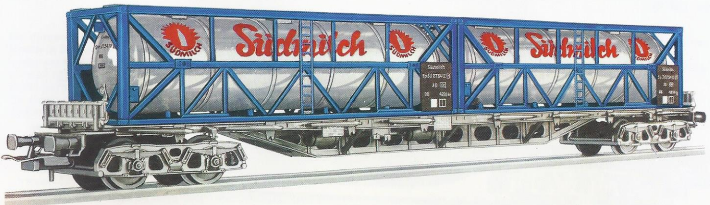
DB-Mehrzweck-Tragwagen Sss-y-716 beladen mit 2 x 30' Iso-Tank-Containern der Firma Südfrisch AG. Behälter entsprechend dem Vorbild blank metallisiert und beschriftet. Kran- und stapelbar. 2402 DM 19,50
