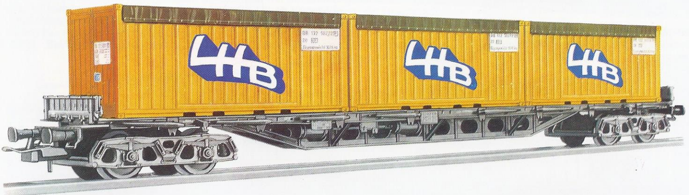
DB-Mehrzweck-Tragwagen Sss-y-716 beladen mit 3 x 20' Iso-Open-Top-Stahl-Container der Waggonfabrik Linke-Hofman-Busch AG Salzgitter, diese Firma fertigte und fertigt den Tragwagen Sss-y-716 für die DB! 2409 DM 18,50
