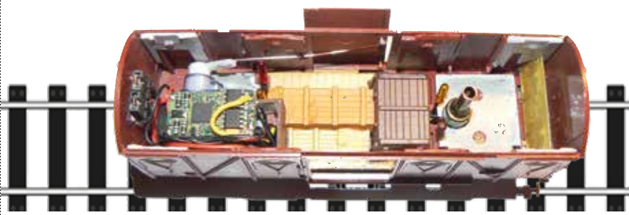
H0-Güterwagen mit Digital-Servo, das eine Wagentür öffnet, und Digitaldecoder für Licht und Rauch
