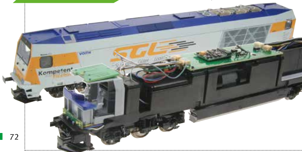
Voith Maxima mit PluX22 Decoder, Soundmodul 32 300 und Lautsprecher 31 140
