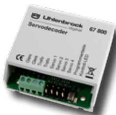
An dem Servodecoder 67800 können bis zu 4 Servos angeschlossen werden.
