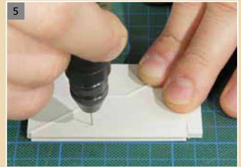
Nachdem die beiden Wandteile mit einem Seitenschneider abgetrennt wurden, legen Sie sie absolut deckungsgleich übereinander und bohren mit einem 0,5 mm Bohrer an den markierten Stellen. Somit wird gewährleistet, dass die Handläufe an beiden Wänden in gleicher Höhe angebracht werden.
