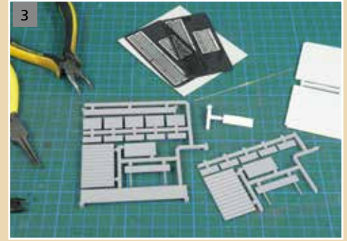
Außer den im Bausatz befindlichen Teilen werden noch zwei für den Modellbau geeignete Flachzangen, ein kleiner Seitenschneider sowie Stahlleine, Bleistift, Farbe, Sekundenkleber Art. 53 513 und 0,5 mm Messingdraht, erhältlich in gut sortierten Fachgeschäften für Bastelartikel, benötigt.
