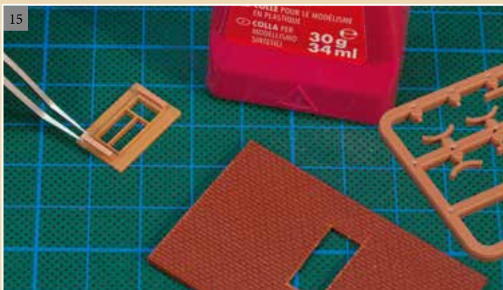
Durch die Verarbeitung der originalen Fensterbänke und -stürze, müssen die Ausschnitte in der Höhe entsprechend größer sein. Beides fixiert man vor dem Einbau des Fensters auf dem Kleberand.
