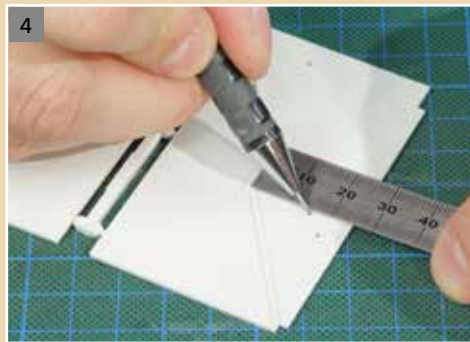
Zuerst werden die Löcher für die Befestigung der Handläufe siehe bemaßte Zeichnung markiert.
