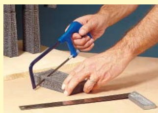
Der Brückenpfeiler wird gekürzt.
