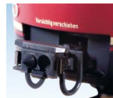
Funktionsfähige Scharfenberg-Kupplung ohne Abdeckung.
