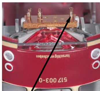
Kontaktfedern für optimale Stromabnahme der Beleuchtungsplatte.
