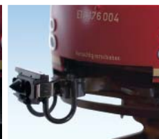
Funktionsfähige, kurvengängige Kupplung mit abgenommener Sichtschürze.
