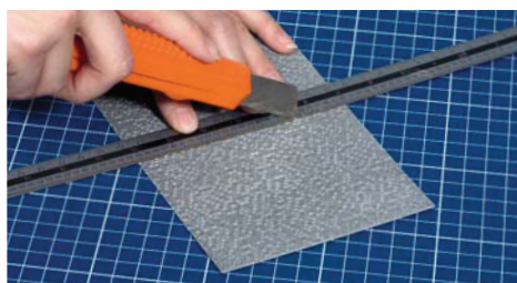
Bastelplatte einfach mit dem Cutter zuschneiden. Simply cut the texture sheet with a cutter.
