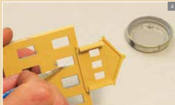
Fensterleibung und Zwischenräume mit Pinsel und Farbe nacharbeiten. Use a brush and paint to enhance the window openings and spaces.
