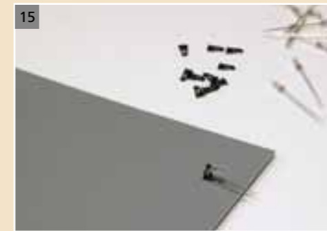
Die Drähte werden links und rechts am Kunststoffteil vorbeigeführt. – Wichtig!
