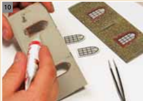
... Fenster von innen einkleben. Dabei Leim auf die Wand auftragen.
