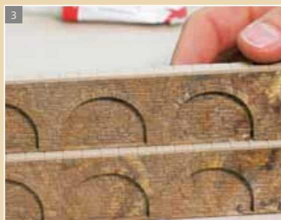
Dann die Arkadenteile übereinander kleben. Das obere wird auf der hinteren Kante der unteren Abdeckung fixiert. Damit entsteht eine Abtreppung.
