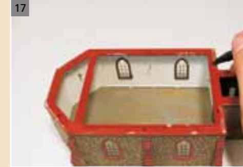
Zur Vorbereitung der Verdrahtung im Rahmen pro Lampe ein Bohrloch anzeichnen und bohren. Dann verdrahten und Funktion überprüfen.
