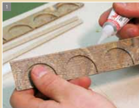
Die Arkadenteile mit UHU Plast bestreichen...
