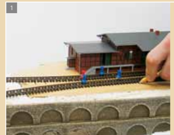
Mit dem Bleistift Lage der Gleise anzeichnen, danach Gleise aufkleben und fixieren bis der Leim ausgehärtet ist.
