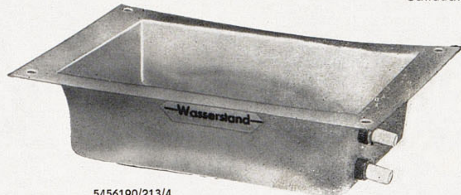
5456190/213/4 Wasserfangschale PVC tiefgezogen, Fassungsvermögen 0,3 Liter.
