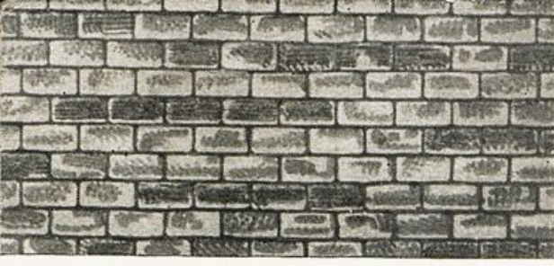
5/01 regelmäßiges Natursteinmauerwerk Format 11 × 23 cm M -,18
