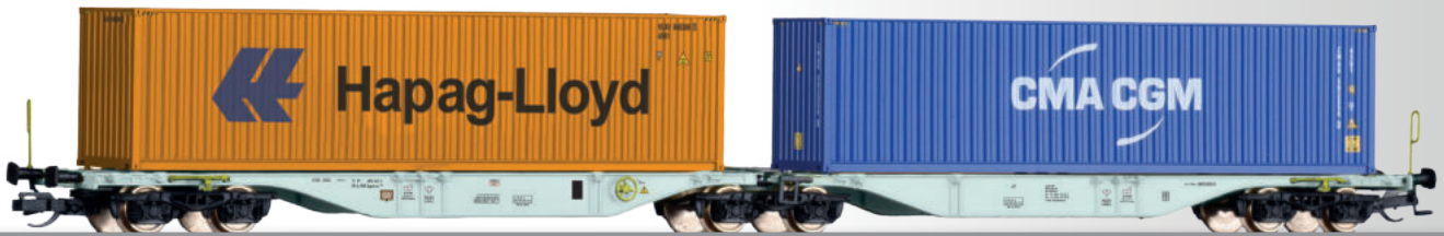
Containertragwagen Sggmrss 578.0 der ÖBB, beladen mit zwei 40'-Containern Container car Sggmrss 578.0 of the ÖBB with load
