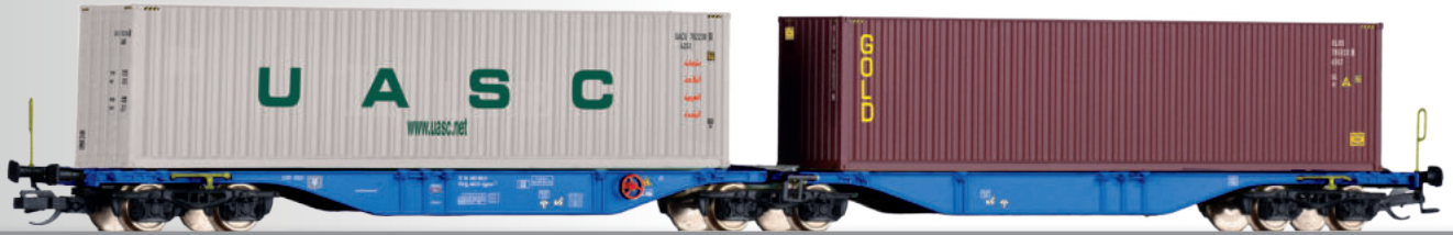
Containertragwagen Sggmrss der NACCO, beladen mit zwei 40'-Containern Container car Sggmrss of the NACCO with load
