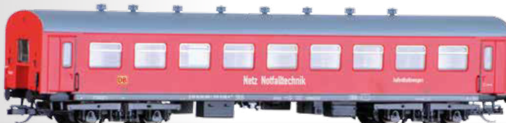
Standard-Hilfszug der DB Netz Notfalltechnik, bestehend aus drei Wagen Standard maintenance train of the DB Netz Notfalltechnik with three wagons
