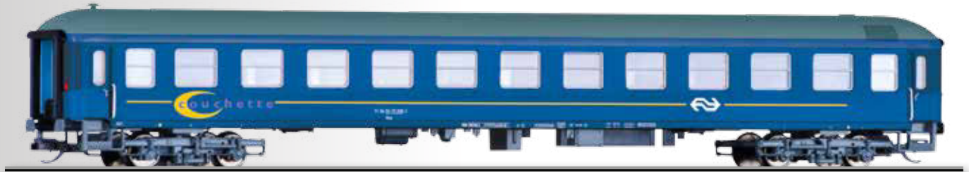
Liegewagen 2. Klasse Bcm der NS 2nd class couchette coach Bcm of the NS
