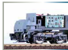
Decoder eingebaut / Installed decoder
