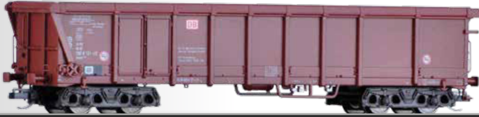
Rolldachwagen Tamns 893 der DB AG, vermietet an Berzelius Umwelt-Service Sliding roof cars Tamns 893 of the DB AG
