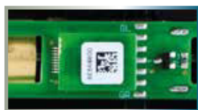
Entstörersatz eingebaut / Installed interference sup- pression set
