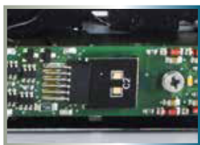
Entstörersatz eingebaut / Installed interference suppression set
