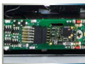
Decoder eingebaut / Installed decoder
