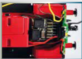
Entstörsatz eingebaut / Installed interference suppression set
