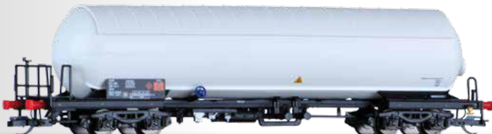
Gaskesselwagen Zacns der ATIR-RAIL Gas tank car Zacns of the ATIR-RAIL • Mit Sonnenschutzdach / With sunshield
