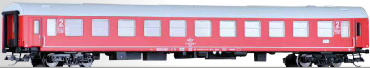
Liegewagen 2. Klasse, Bauart Halberstadt, der OSE 2nd class couchette coaches, type Halberstadt, of the OSE
