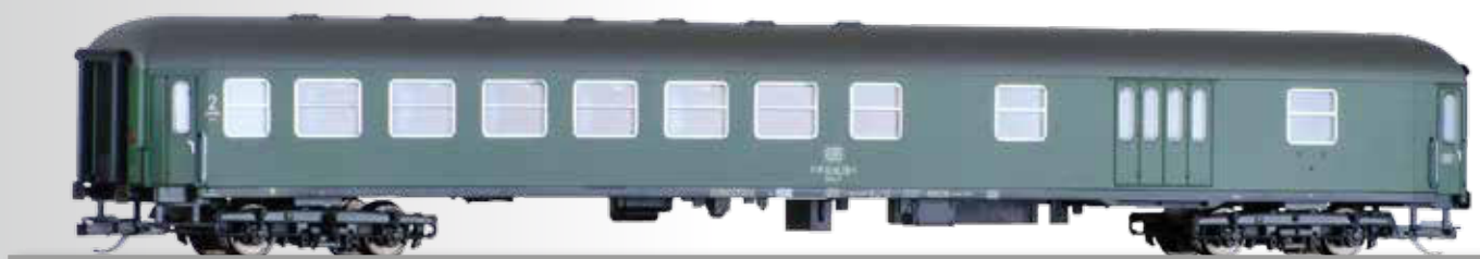
Reisezugwagen 2. Klasse Bm 273 mit Gepäckabteil der DB 2nd class passenger coach Bm 273 with baggage compartment of the DB
