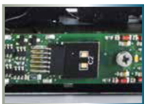
Entstörersatz eingebaut / Installed interference suppression set
