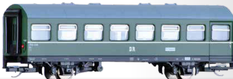
Reisezugwagen 2. Klasse Bgtr mit Traglastenabteil der DR 2nd class passenger coach Bgtr of the DR
