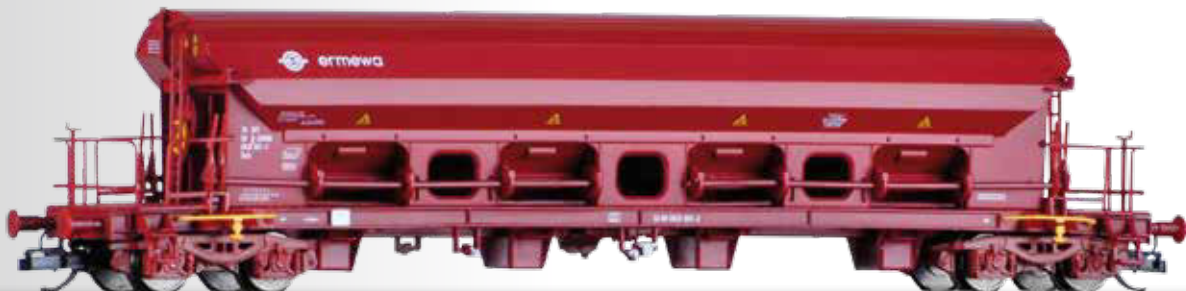
Güterwagenset der Ermewa / LOVOCHEMIE, bestehend aus zwei Schwenkdachwagen Tads (B) Freight car set of the Ermewa / LOVOCHEMIE with two swing roof cars Tads (B)
