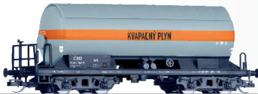
Gaskesselwagen Ra „KVAPALNY PLYN “ eingestellt bei der ČSD, mit Sonnenschutzdach Gas tank car Ra „KVAPALNY PLYN “ of the ČSD, with sunshield
