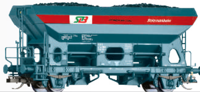
Selbstentladewagen Fcs der Steiermärkischen Landesbahnen Hopper car Fcs of the Steiermärkischen Landesbahnen
