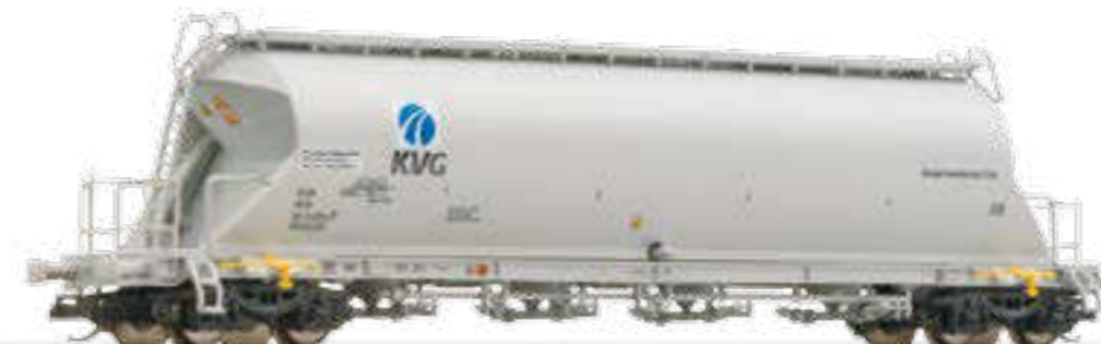
Staubbehälterwagen der KVG, eingestellt bei der DB AG Silo car „KVG“ of the DB AG
