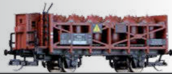
Säuretopfwagen „IG Farben-industrie“, eingestellt bei der DRG Acid pot car „IG Farbenindustrie“ of the DRG
