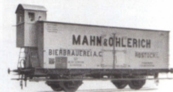
Zweiachsiger Bierwagen Nr. 600 026 Einsteller "Mahn & Ohlerich Bierbrauerei AG Rostock" Baujahr 1907
